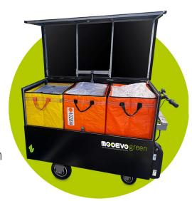
Capacidad de carga: 500/750L Potente: 2 motores 500W
